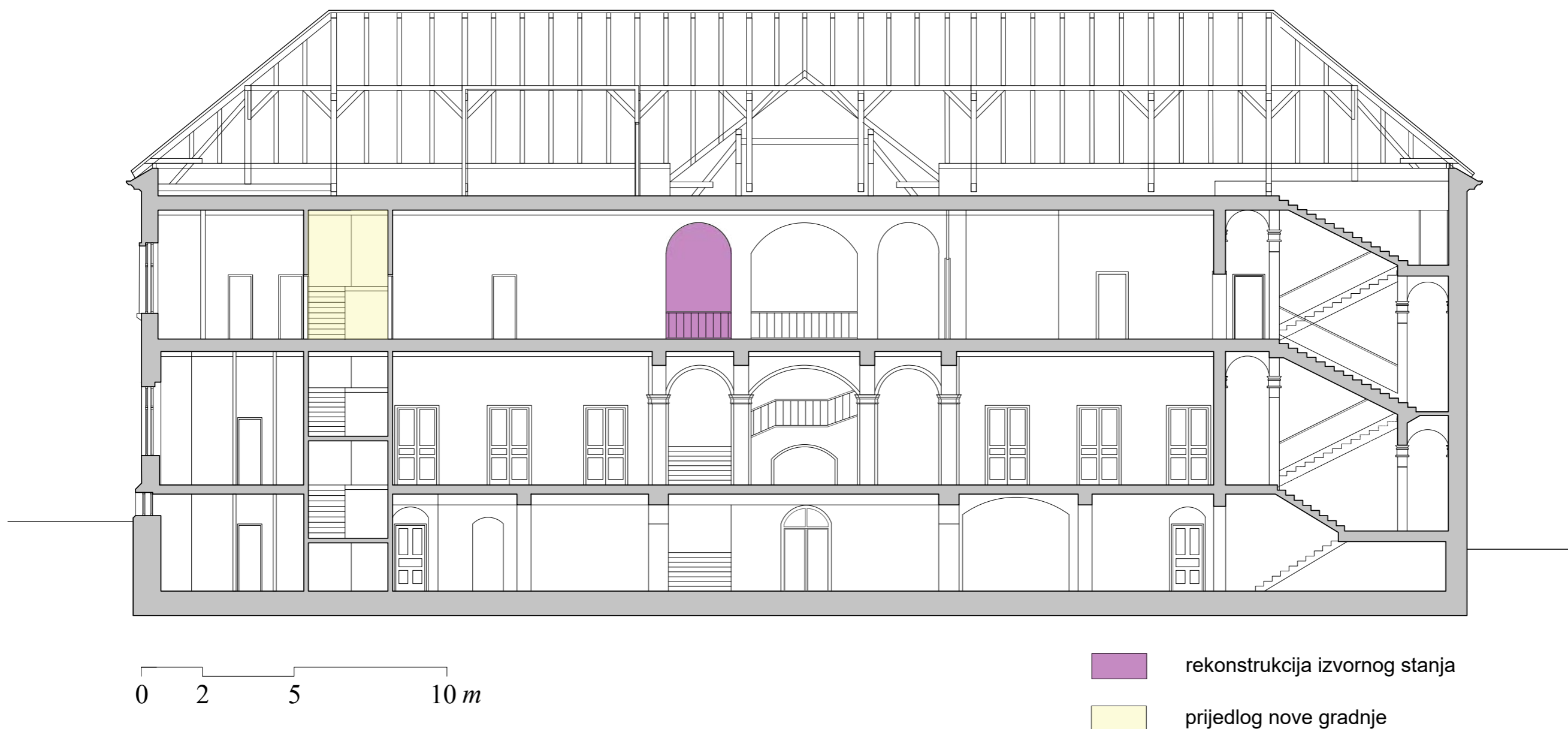
Presjek s pogledom na jug s označenim smjericama za obnovu
