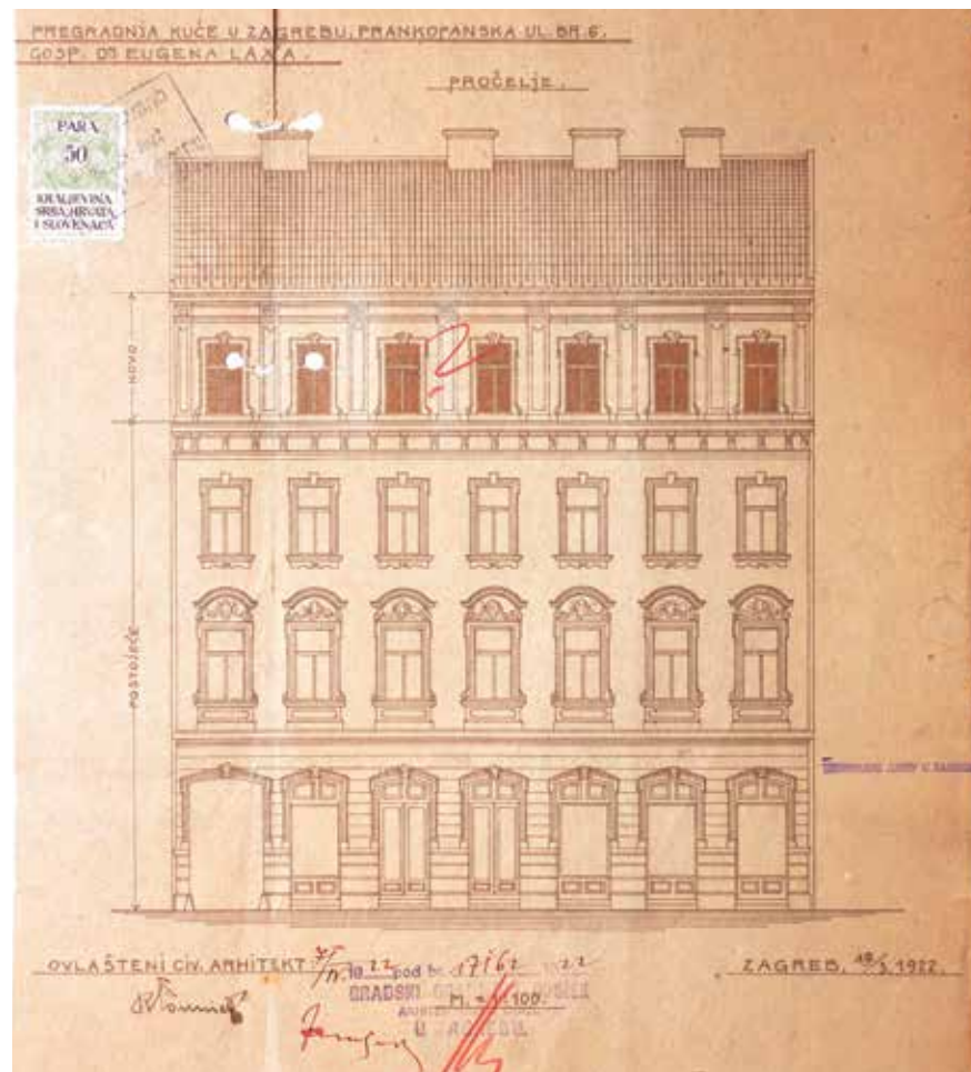
Projekt dogradnje trećeg kata, 1922., pročelje (neizvedeno), DAZ
