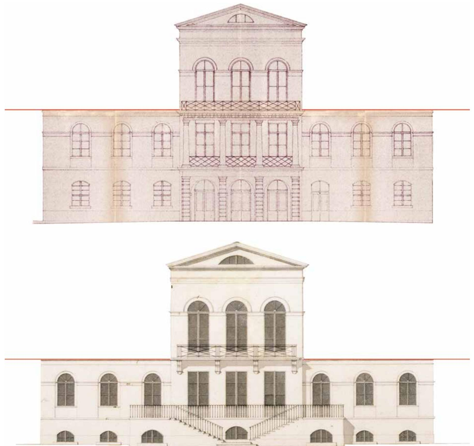
Altana na istočnom pročelju: usporedba izvedenog i izvorno projektiranog stanja
