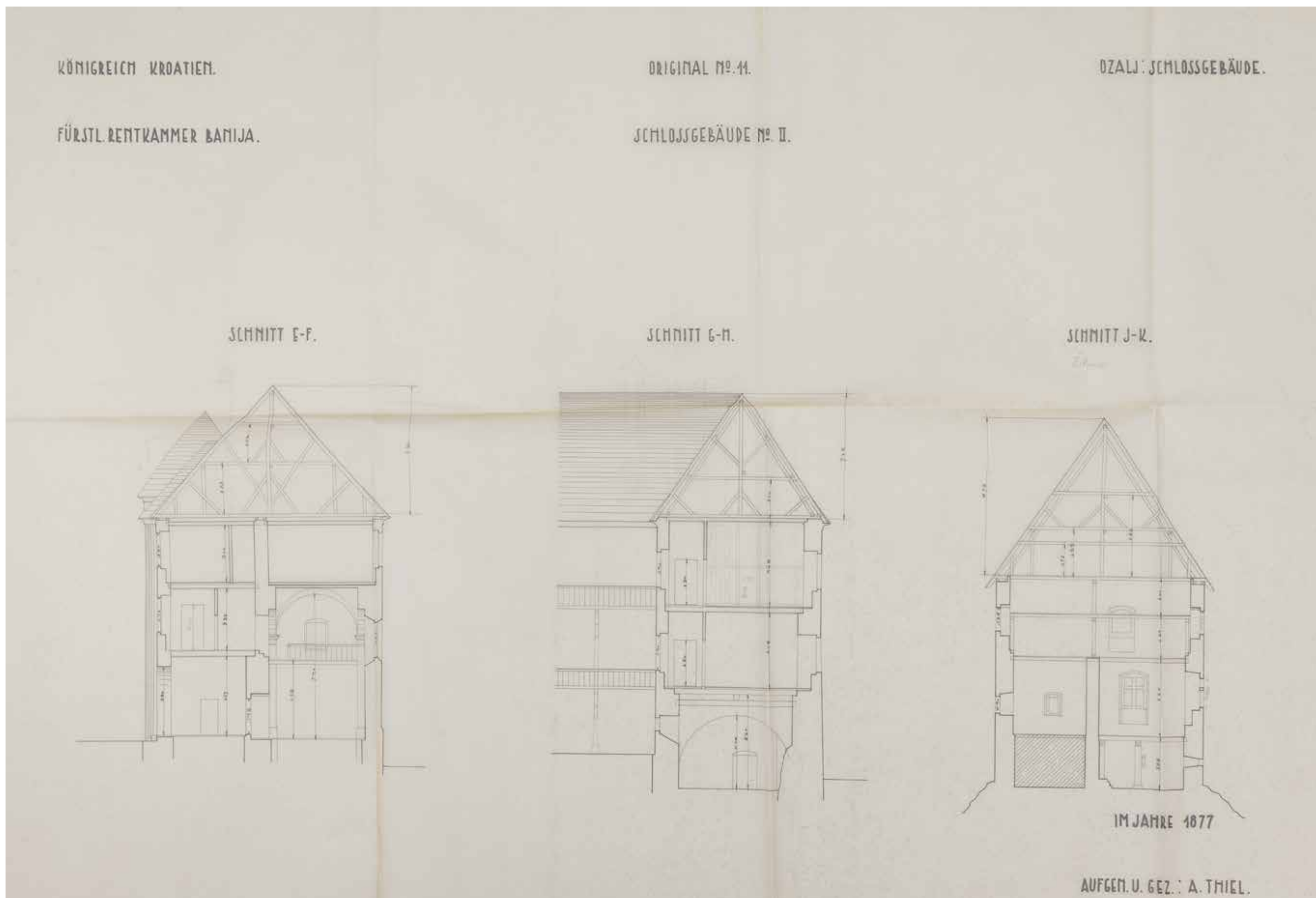
Stari grad Ozalj, presjeci kroz sjeverno krilo i kapelu (E-F), južno krilo s pogledom na istočno krilo (G-H) i Žitnicu (J-K), 1877. (DAZG)
