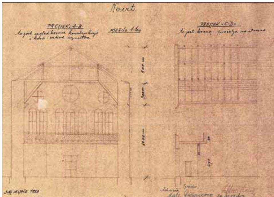
*Projekt za novo crkveno pročelje – poprečni i uzdužni presjek, Mate Dragičević,
