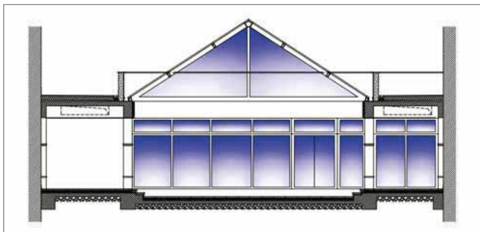
*Poprečni presjek samostanskog klaustra sa staklenim pokrovom,
