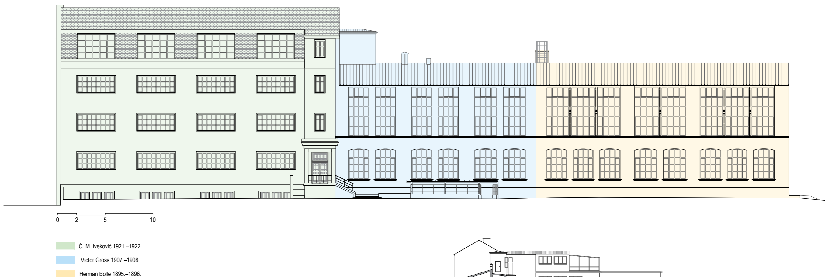
Sjeverno pročelje s označenim fazama gradnje
