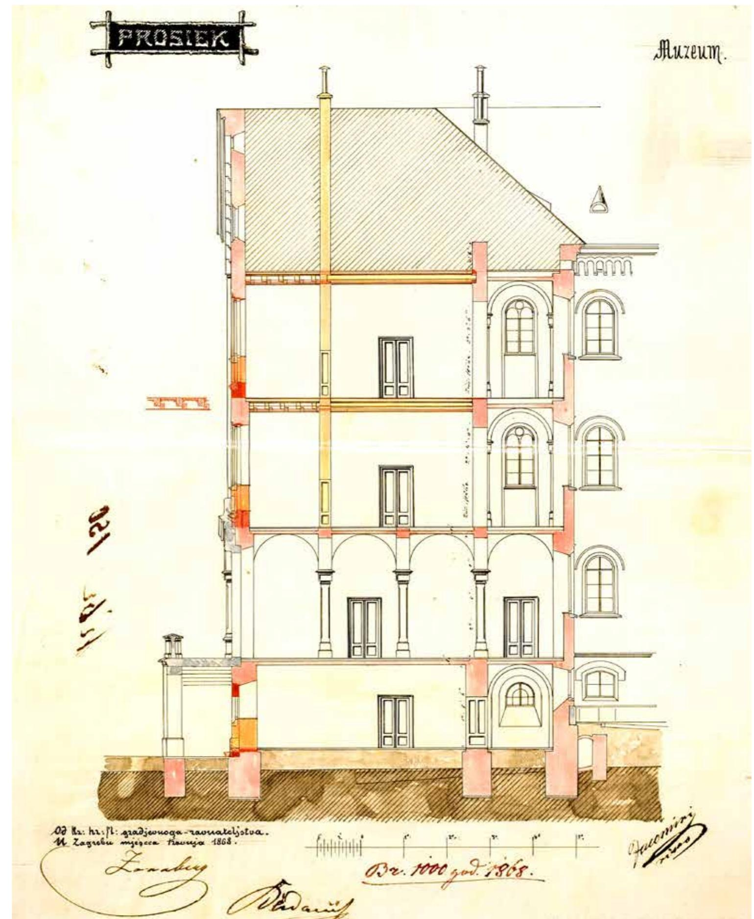
Projekt prenamjene zgrade Opće bolnice u sjedište JAZU, 1868., presjek kroz vestibul s projektiranim stupcima identičnim neoromaničkim stupcima u bočnom stubištu
