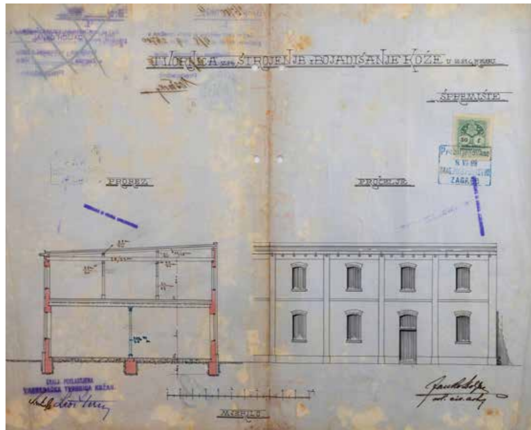
Nacrt za skladište trijesla i koža u Zagrebačkoj tvornici koža, M. Pilar, Gustav Pongratz, 1895., DAZG
