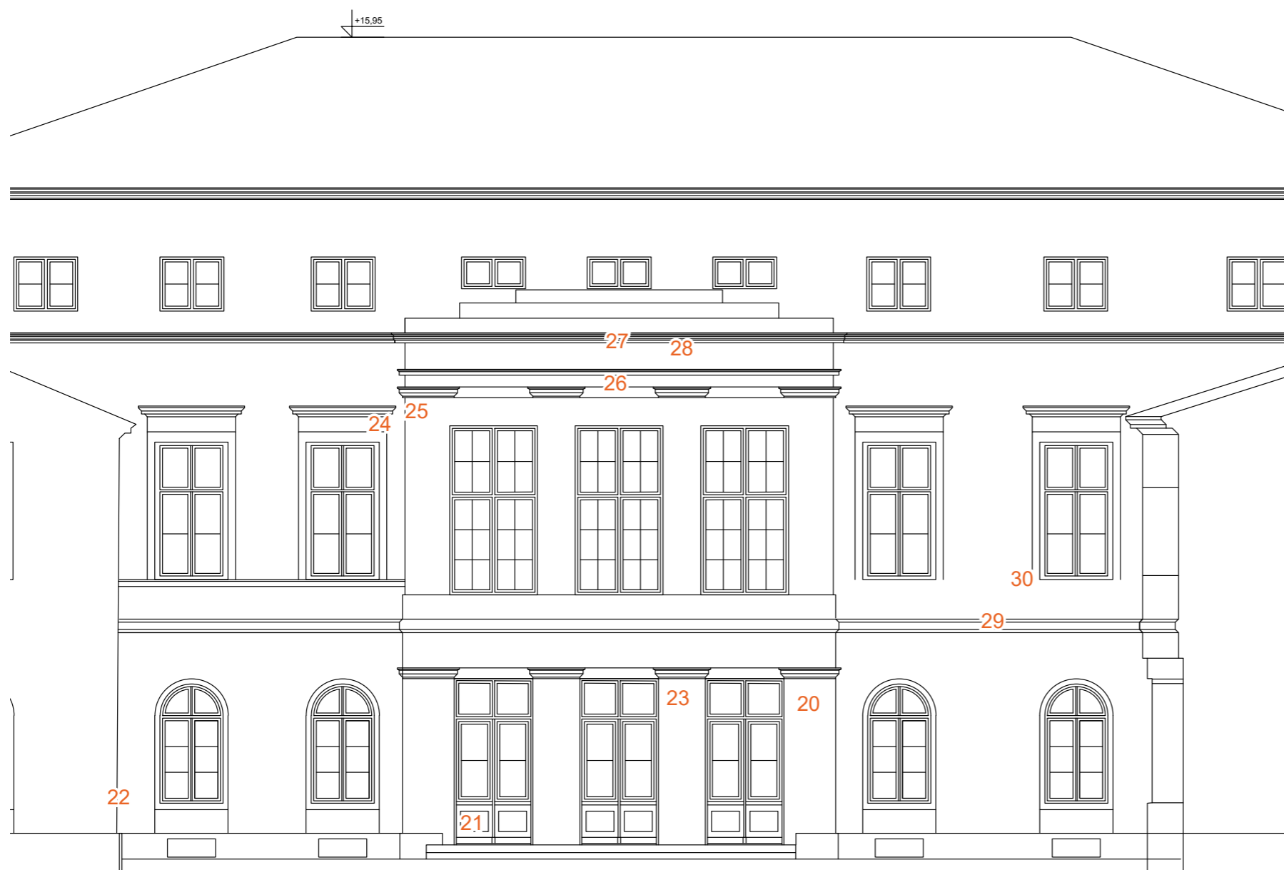
Nacrt zapadnog pročelja s upisanim pozicijama sondiranja
