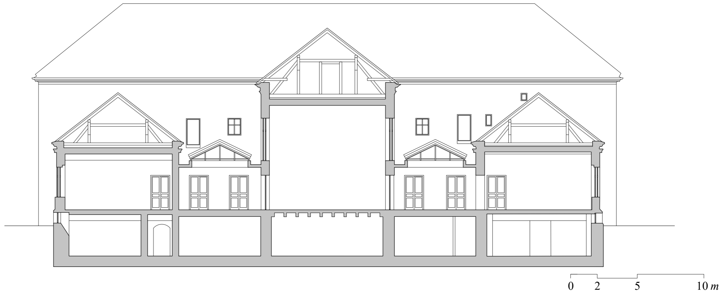
Presjek kroz bočna krila (zapadno i istočno), natkrivene atrije i središnju dvoranu, s pogledom na sjever, postojeće stanje (veljača 2022.)
