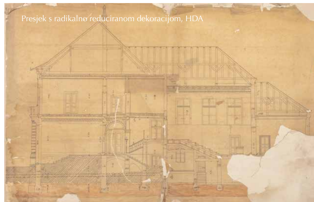
Herman Bollé, presjek kroz jednokatno sjeverno krilo s predvorjem i glavnim stubištem, predavaonicu i južno prizemno krilo
