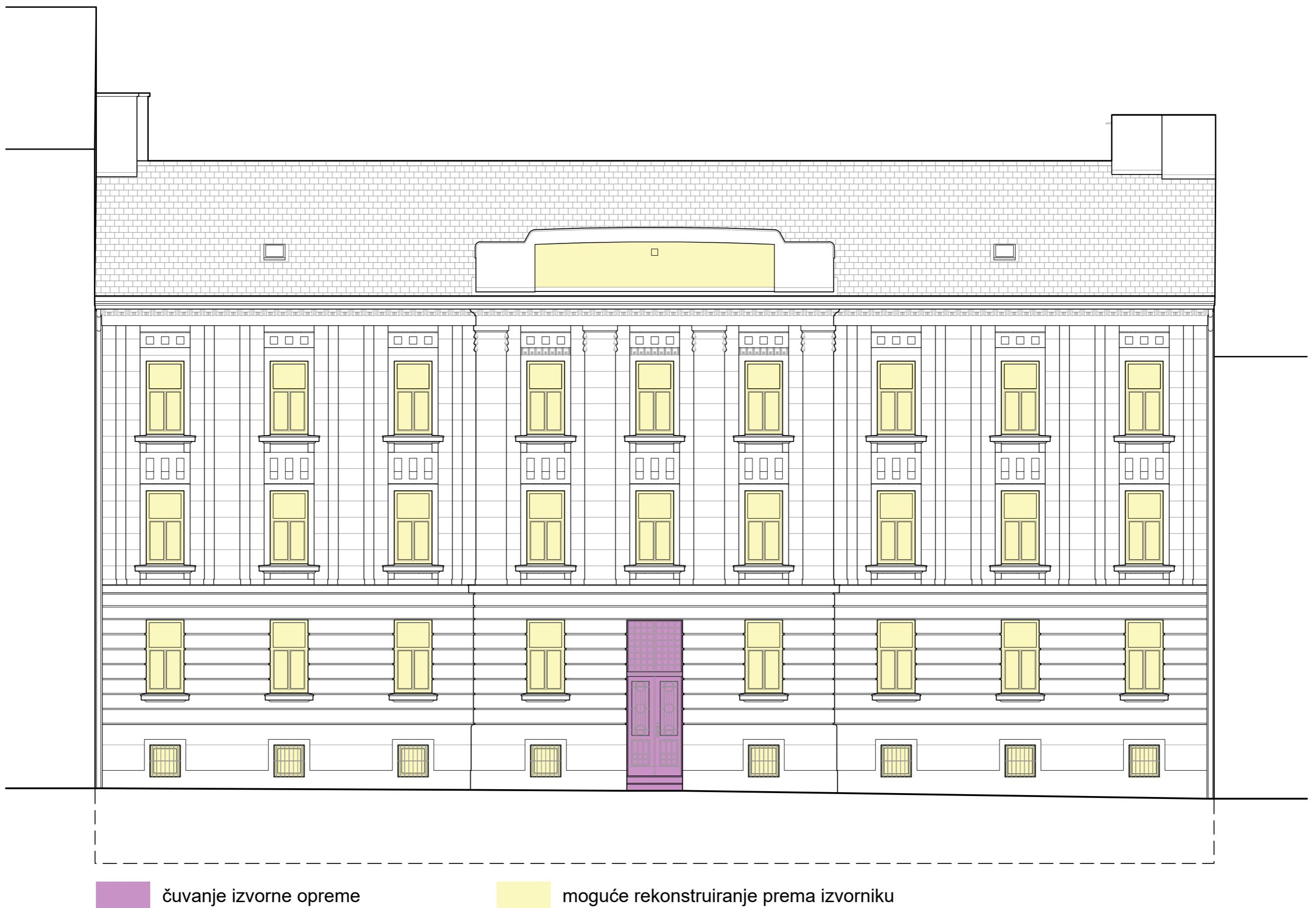
Nacrt južnog pročelja s označenim smjernicama za obnovu
