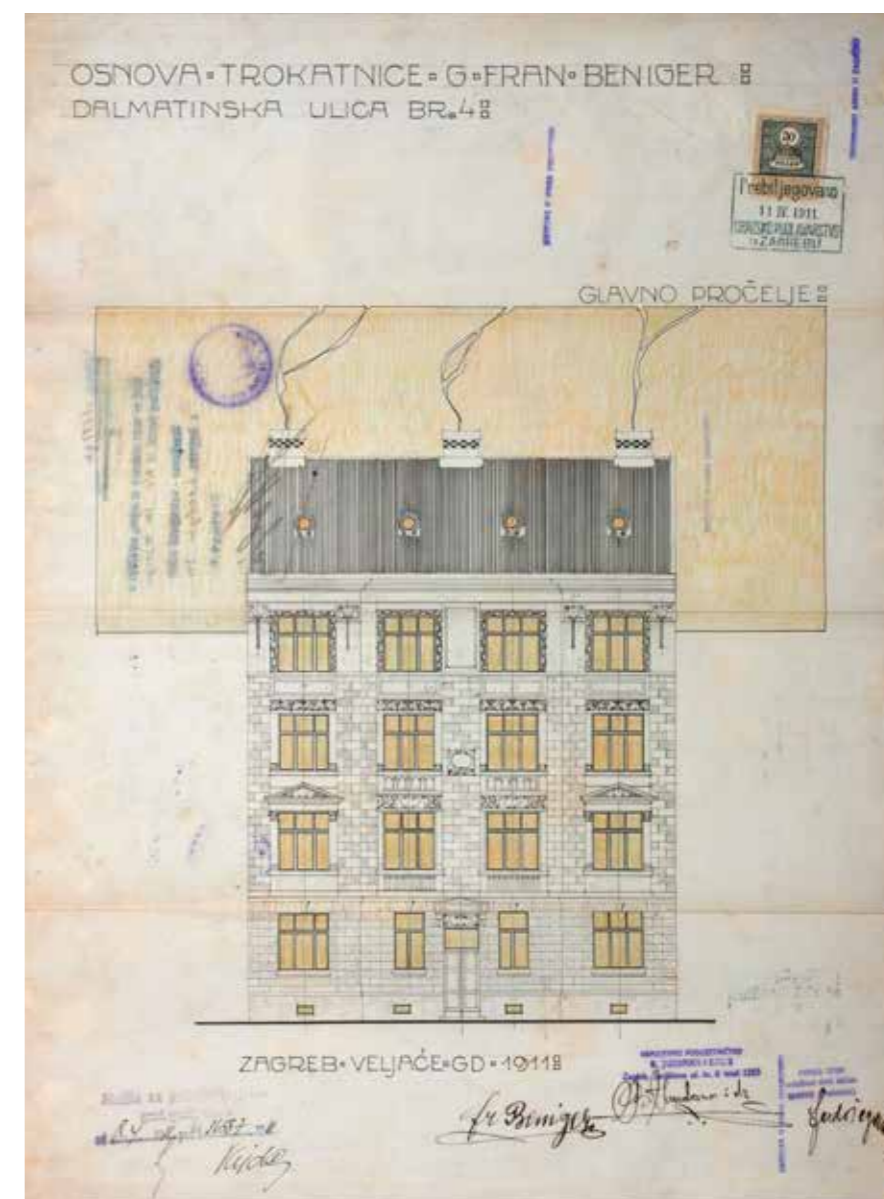
Kuća Beniger, projekt, B. Jurdana, 1911., tlocrt podruma prizemlja i katova, presjek kroz stubište i pročelje (bez erкера), DAZ
