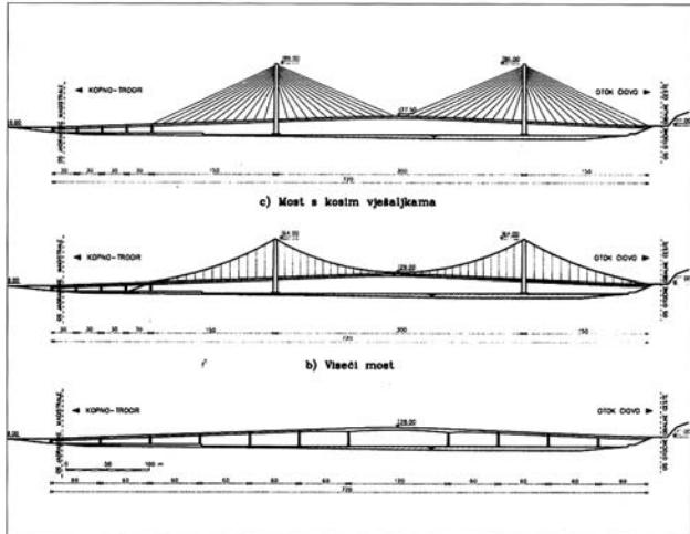
Prvi prijedlozi za izgradnju novog mosta kopno – otok Čiovo. Ogorčna tehnička konstrukcija pregradičala bi Kaštelanski zaljev i zatvorila vizuru prema jezgri Trogira kada joj se prilazi morem s istoka.
