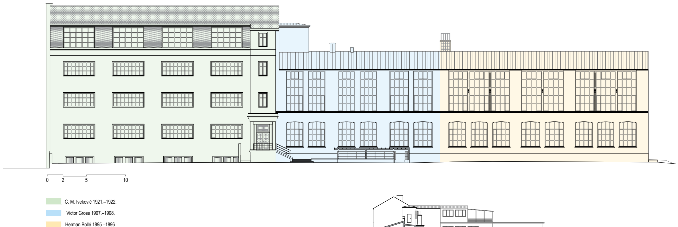
Sjeverno pročelje s označenim fazama gradnje
